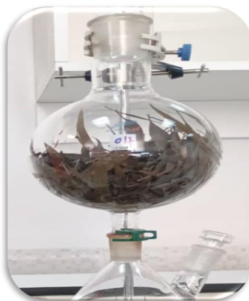
Figure 6 : Kit d'hydrodistillation à vapeur.
