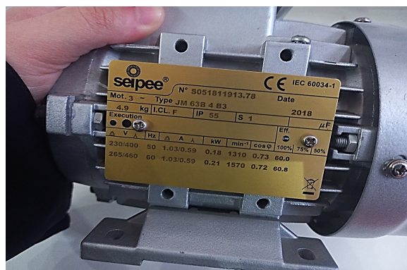
FIGURE II.2 – Plaque signalétique d'un moteur asynchrone triphasé (atelier génie électrique-ENSTI Annaba)
