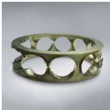
(4) Endommagement de la Cage
