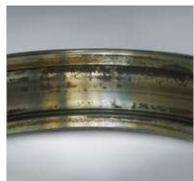
(10) Rouille et Corrosion
