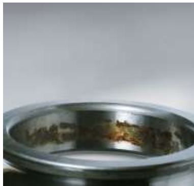
(7) Usure de Contact
