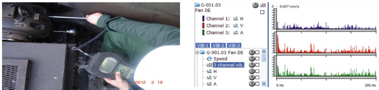
Figure I.11 Exemple de suivi d'une machine par analyse vibratoire
