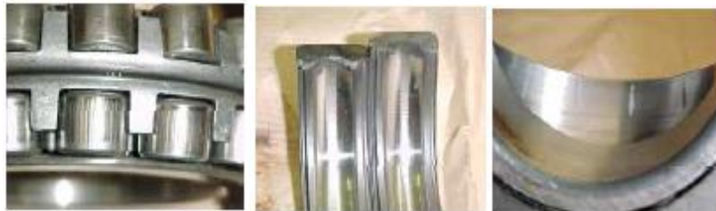
Figure III.19 défaut de bagues et éléments roulants
