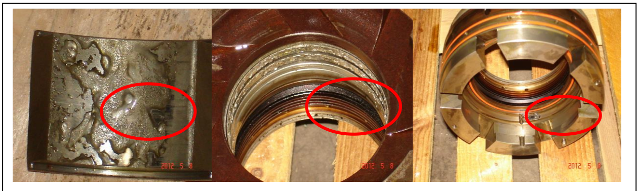
Figure I.10 Dégradation des paliers par l'usure
