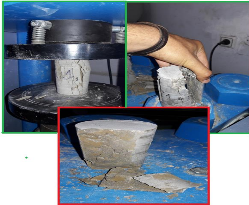
Figure IV-9: photo de l'échantillon écrasé
