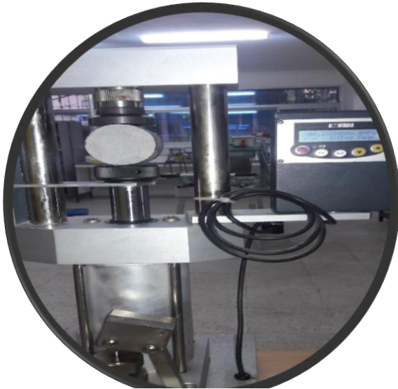
ANNEXE I.10 : photo de la machine de l'essai brésilien
