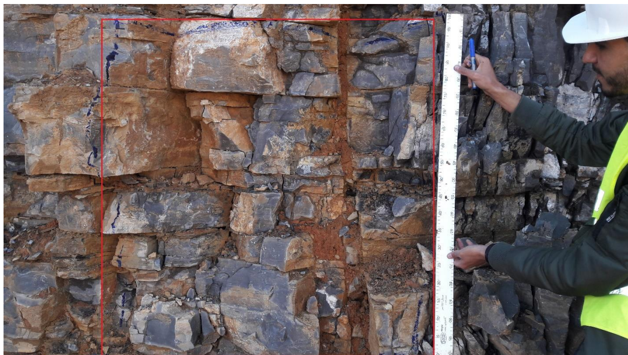
ANNEXE I.13 : photo représentant le nombre de fissure dans 1m 2
