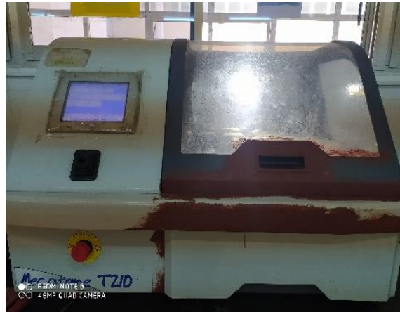
Figure 4 : Micro tronçonneuse de type MECATOME utilisée pour le découpage des échantillons.
